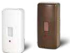
Infrarosso tenda per la protezione interna di porte e finestre. Fascio di copertura selezionabile a 2,5 o 5 m. Ingresso ausiliario programmabile come zona di allarme o per contatto a cordino con conteggio digitale degli impulsi. Supervisionato, batteria a litio in dotazione. Dimensioni (L x H x P in mm): 40 x 89 x 30.
