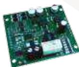
Modulo Plug & Play per centrale **WILMA**. Consente il collegamento ad un apparecchio telefonico (PABX analogico, telefono analogico) per effettuare e ricevere chiamate attraverso il modulo GSM della centrale. Non adatto a segnalazioni FSK, tipo modem e/o fax digitali.
