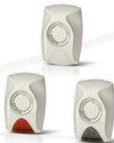
Sirena piezoelettrica su BUS RS485 da interno autoalimentabile con batteria per segnalazione di taglio fili. Funzionamento su BUS anche senza batteria. Disponibile in versioni con o senza lampeggiante a LED. Potenza sonora regolabile direttamente da centrale e fino a 8 differenti toni selezionabili. Struttura in ABS bianco. Controllo stato batteria con segnalazione SMS. Batteria non inclusa. Dimensioni (L x H x P in mm): 115 x 150 x 55.
