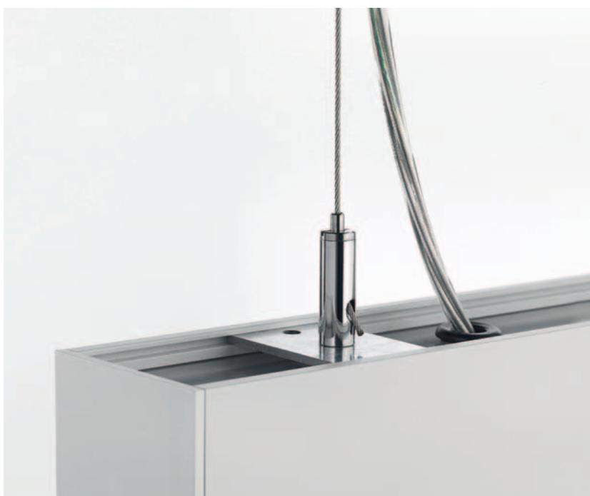
L'installazione di Segno è rapida, semplice ed intuitiva; una volta fissati a soffitto i moduli strutturali già precablati, si montano i moduli ottici con un semplice click grazie al sistema di fissaggio magnetico incorporato. Il collegamento elettrico dei moduli ottici è in bassissima tensione e avviene senza utensili grazie all'apposito "fast plug". Il sistema di regolazione della lunghezza del cavo di sospensione è facilmente accessibile perché collocato direttamente sul modulo strutturale.
