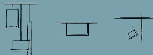
Lampada a sospensione, a soffitto e a parete con sorgente LED (2700K), struttura ovale in pressofusione di alluminio (spessore 1mm) verniciata a polveri nei colori bianco, nero e tortora. Composta da tagli tondi nella struttura da cui fuoriesce la luce: proposta in diverse misure e con diversi tagli (due, tre, quattro o cinque).
