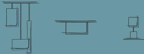
Lampada a sospensione, da tavolo e a soffitto con diffusore in vetro soffiato bianco satinato lavorato a mano. La struttura interna, visibile dai fori della lampada, è tornita a mano in metallo cromato. Cablata con attacco tradizionale (G9 o E27) che consentono di montare lampadina LED.
