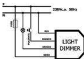
Variatore universale che permette di regolare tutte le lampade ad incandescenza, alogene, LED purché del tipo dimmerabile. Dispositivo azionabile tramite uno o più pulsanti NA, con collegamento indifferente su fase o su neutro.
