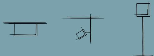
Lampada da soffitto, da parete e da terra con attacco R7s che consente di montare lampadina LED. Struttura in metallo cromato con diffusore in vetro pirex satinato orientabile sull'asse orizzontale, con diffusione luminosa a 360°.
