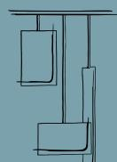
Apparecchio a sospensione a LED (3000K) con alimentatore integrato nel rosone. Struttura in pressofusione di alluminio verniciato disponibile nei colori bianco e nero. Cavo di sospensione trasparente. Riflettore in alluminio che crea un fascio di luce concentrato (40° o 50°). Disponibile in due altezze e nei diametri di 46 mm e 60 mm, nella versione singola o con rosone lineare da tre elementi in tinta con il corpo lampada.
