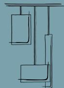
Lampada a sospensione con sorgente LED integrata (3000K). Corpo in alluminio estruso, colore bianco goffrato, verniciatura a polveri epossidiche. Diffusore in policarbonato opale. Disponibile in forma quadrata o rettangolare in diverse dimensioni e relative potenze e in versione dimmerabile DALI.
