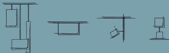
Lampada a sospensione, a soffitto, da parete e da tavolo in vetro curvo, satinato centralmente con bordo trasparente. Struttura in metallo verniciato, dettagli e finiture cromate. Proposta in versione con LED integrato (2700K) o con attacco tradizionale che consente di montare lampadina LED.
