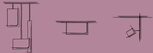
Lampada a sospensione, da soffitto e da parete, con struttura in metallo cromato e strass decorativi che creano giochi di luce sulla superficie su cui viene installata la lampada. Prodotto dalle dimensioni contenute ma altamente decorativo. Cablato con attacco E14 che consente di montare lampadina LED.
