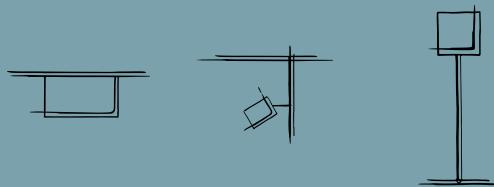
Lampada da soffitto, da parete e da terra composta da un braccio orientabile in fase di montaggio tramite una vite che fissa la struttura nella posizione desiderata. Struttura in metallo cromato, diffusore in vetro pirex serigrafato per un'ottimale diffusione della luce. Versione a parete con elemento rigido per spostamento del punto luce.
