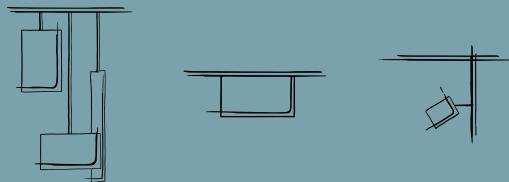
Lampada a sospensione, da parete e a soffitto con sorgente LED (2700K); la luce esce dai tagli quadrati nella struttura (diversi a seconda delle dimensioni). Struttura in pressofusione di alluminio (spessore 1mm) verniciata a polveri nei colori bianco e tortora. Prodotto molto sottile, ideale per l'installazione nelle abitazioni moderne.
