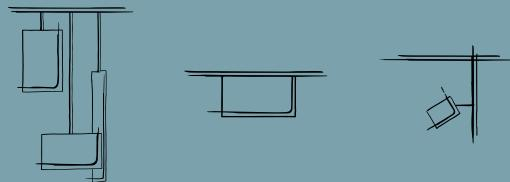
Lampada a sospensione, da parete e a soffitto con sorgente LED (2700K); la luce esce dai tagli rettangolari nella struttura. Struttura squadrata in pressofusione di alluminio (spessore 1mm) verniciata a polveri nei colori bianco, nero e tortora. Prodotto molto sottile, ideale per l'installazione nelle abitazioni moderne.
