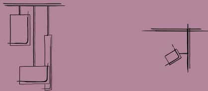
Lampada a sospensione e da parete con struttura in metallo ottonato (oro lucido). Tazze portalampada rivolte verso il basso in vetro satinato. Applique con accensione tramite corda tiretto. Cablata con attacco E14 che consente di montare lampadina LED.
