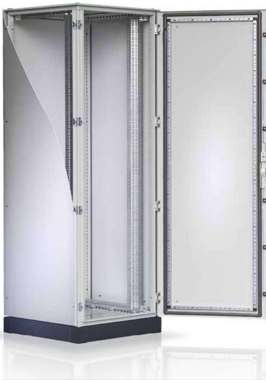
Realizzati per rispondere a particolari esigenze di installazione, soprattutto in ambito industriale, gli armadi **Serie IP per applicazioni Server e Datacenter**, grazie all'elevato grado di protezione IP55, alle dimensioni disponibili e fornibili su richiesta con sistemi di ventilazione forzata, riscaldatore o condizionatore da 900 a 4000W, permettono l'installazione di apparati e server in ambienti di lavoro critici.
