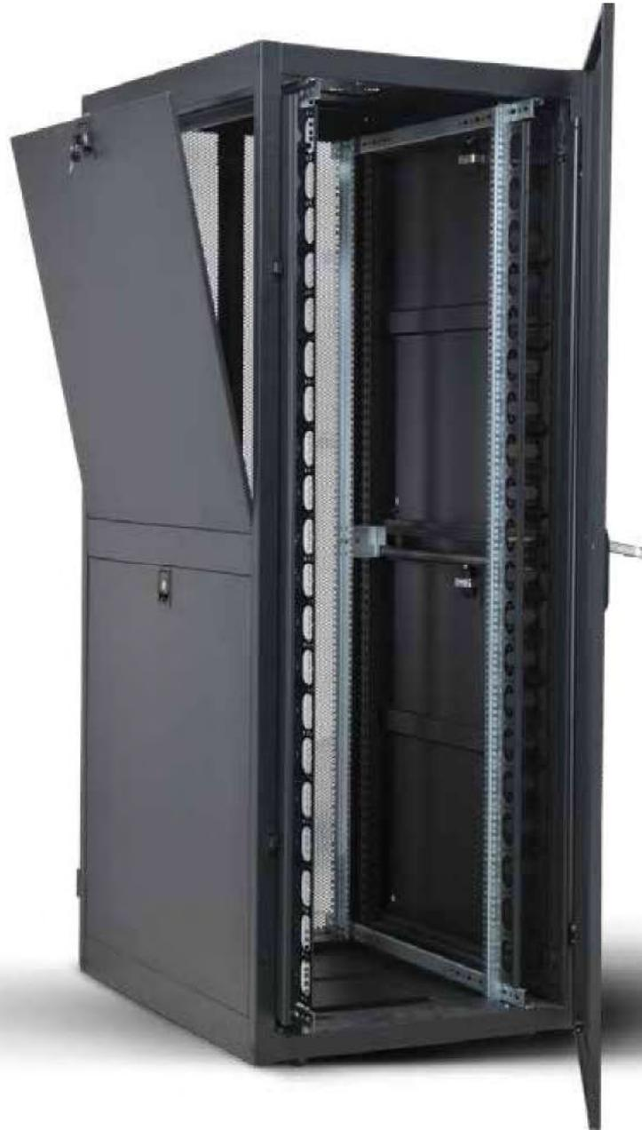
La ricerca di soluzioni in grado di rispondere alle principali richieste di mercato, ha portato alla realizzazione dei nuovi armadi **ad elevata profondità Serie TECH**. Completamente accessoriati, con porte grigliate, pannelli laterali a 2 sezioni, canale laterali passacavi, 4 montanti 19", flange di ingresso cavi regolabili su base e tetto e carico massimo supportato fino a 1300Kg, questa serie di armadi rappresenta la soluzione perfetta per applicazioni Server e Datacenter.
